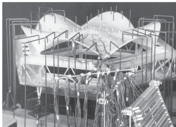
Figura 3. Ensayo sobre modelo de la biblioteca de Basilea, realizado por Hossdorf. (24)
