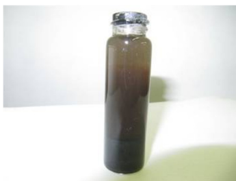
Fig. 19. Muestra de pólvora después del mes 4 bajo las condiciones del ciclo T-HR-t
