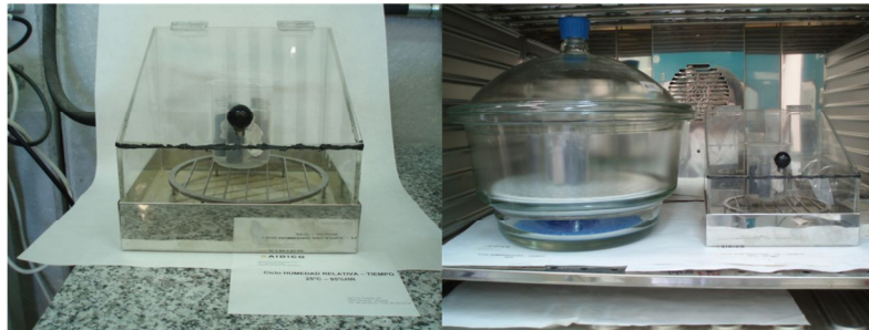
Fig. 5. Disposición de muestras en el ciclo de envejecimiento humedad –tiempo (izquierda) y temperatura – humedad - tiempo (derecha)
