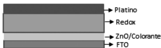
Figura 1. Estructura de las DSSC utilizando ZnO/ Colorante.
