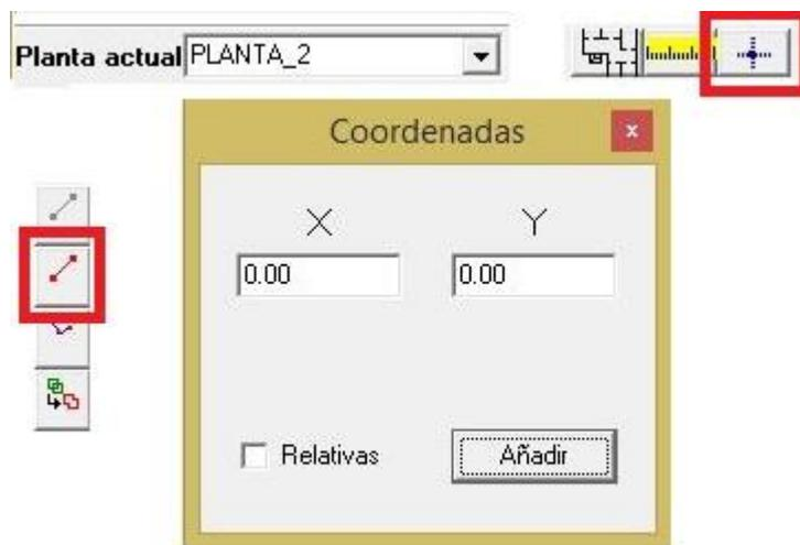
**Figura 20.** Modificación de cubiertas (2) crear líneas auxiliares.
