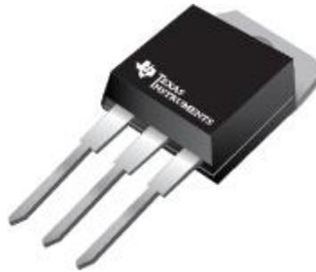
Fig. 2. Regulador lineal de tensión UA7824CKCS. Fuente: <https://www.ti.com/store/ti/en/p/product/?p=UA7824CKCS>
