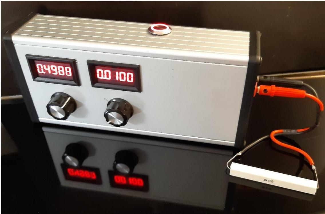
Fig. 52. Carga conectada con la regulación de tensión intentando proporcionar 10V y el límite de corriente ajustado a 10mA. Fuente: Propia
