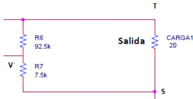
Fig. 55. Divisor resistivo en paralelo con la carga en el circuito BJT. Fuente: Propia
