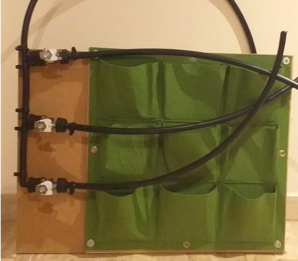
**Figura 95 - Soporte con válvulas de agua y tubos de riego**
