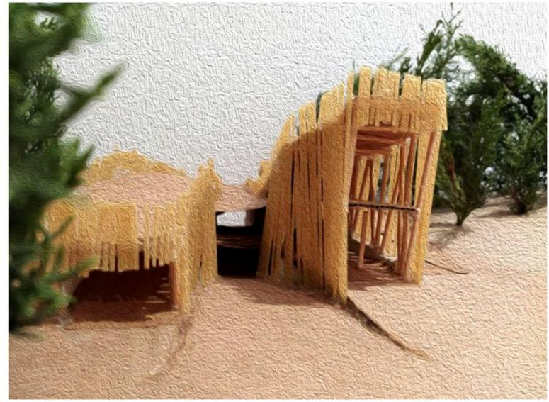
Estos pórticos tienen con dimensión de pilar 30x50, vigas 30x30, anclados entre ellos con fijaciones de acero inoxidable en lacado negro.
