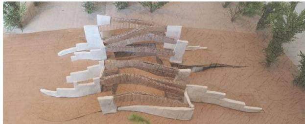
Figura 32. Foto maqueta, parte: vigas centrales, madera laminada. **Elaboración propia.**
