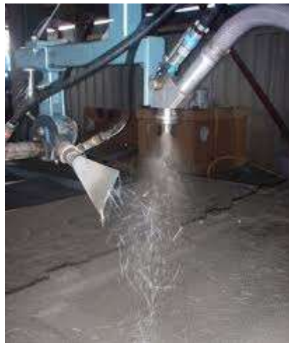
Figura 2.1.6. Proceso de proyección simultánea automática [ https://fibretech.org/grc-guide/production-techniques/05/03/2020 ].
