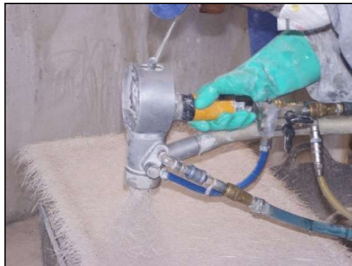
Figura 2.1.5. Proceso de proyección simultánea manual [Elaboración propia].
