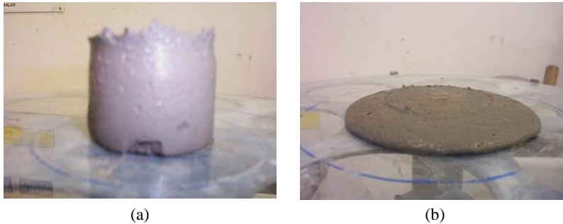
Figura 3.2.2. Pruebas de trabajabilidad para morteros de GRC. (a) Mortero con consistencia inadecuada (b) Mortero con consistencia adecuada.
