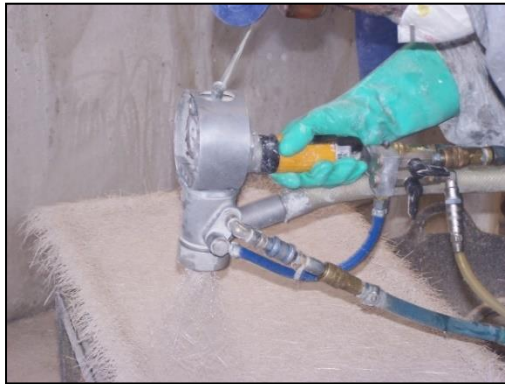
Figura 2.1.5. Proceso de proyección simultánea manual [Elaboración propia].
