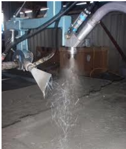
Figura 2.1.6. Proceso de proyección simultánea automática [ https://fibretech.org/grc-guide/production-techniques/05/03/2020 ].
