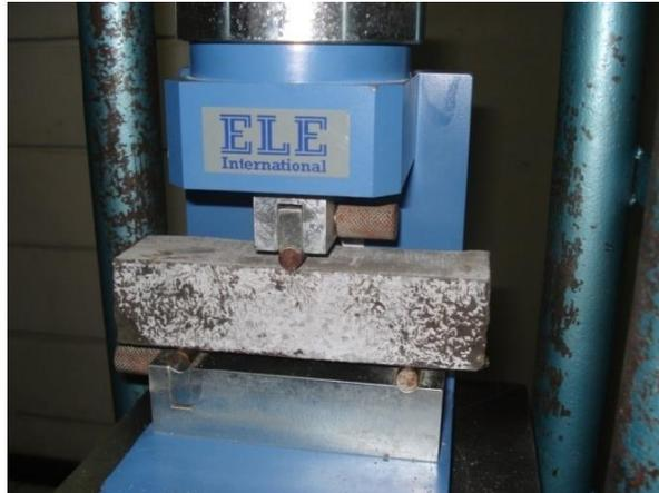
Figura 4. Ensayo resistencia a la flexión. [4]
