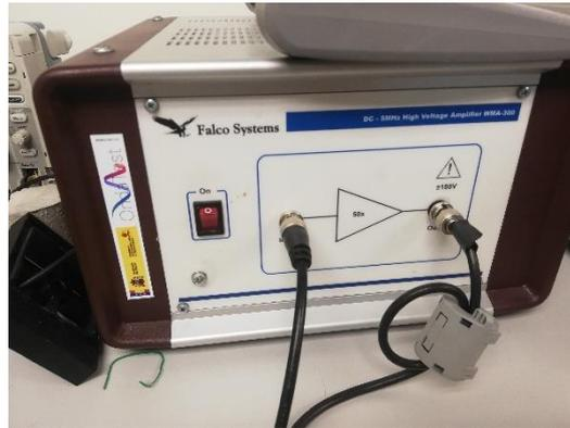
**Figura 23. Amplificador de tensión.**
