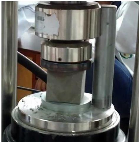
Figura 3. Ensayo resistencia a compresión.
