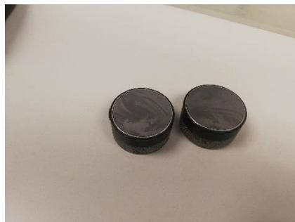
Figura 21. Transductores onda S.
