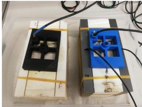
Figura 18. Celda de medida con sensores de temperatura.
