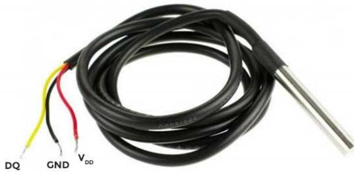
Figura 20. Sensor temperatura celdas de medida.[17]
