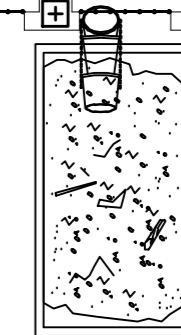
GONDOLA, BAJANTE Y BOCA DE VERTIDOS DE ESCOMBROS
