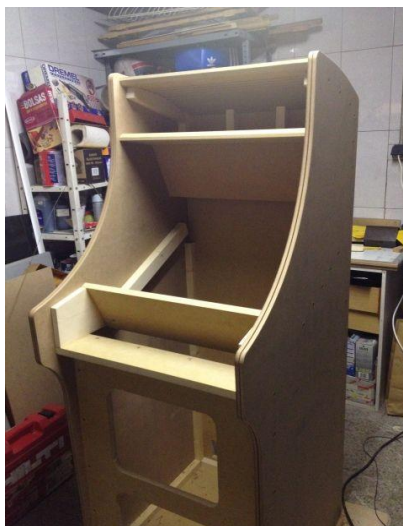
Figura 28: construcción máquina arcade casera con listones en las aristas. Fuente: Pinterest
