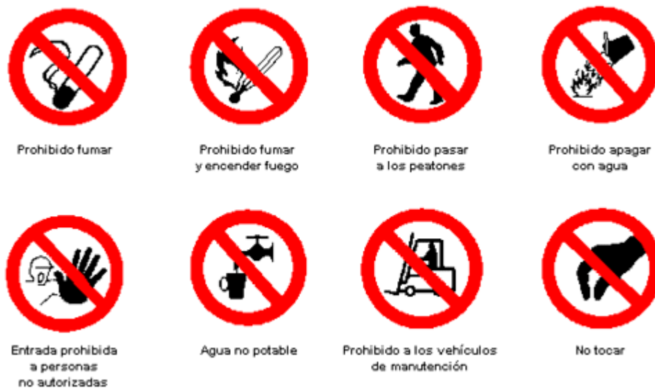
Ilustración 16. Señalización de prohibición. (Fuente: Real Decreto 485/1997)
