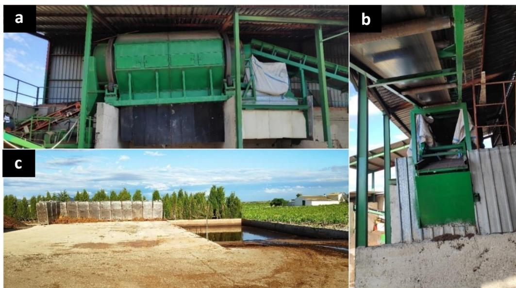
Figura 4.9. a) Tromel. b) Criba. c) Explanada y balsa de humectación para la fibra de coco.
