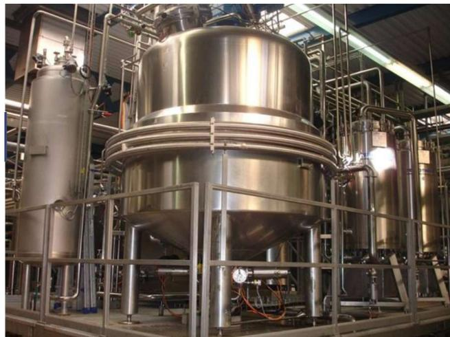
**FIGURA 3.** Instalación completa con calentador óhmico para la preparación de fruta ("Producto - KASAG Swiss AG").
