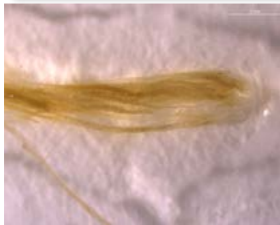
Figura 26. Fotografía de la fibra del tejido del soporte realizada mediante Lupa binocular Leica S8AP0, X10-X80, con sistema fotográfico digital acoplado, donde se aprecia torsión en Z y un ángulo muy abierto. X50.
