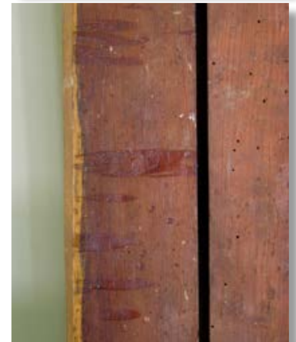
Figura 59. Desgaste de la lámina metálica que deja entrever el embolado.
