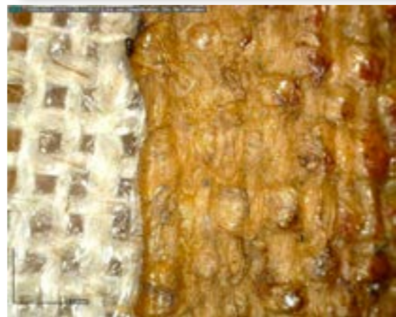
Figura 23. Fotografía de la trama del soporte textil mediante el microscopio digital DinoCapture 2.0. X55.
