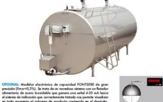
OPCIONAL: Medidor electrónico de capacidad FONTSERÉ de gran precisión (Error <math>\leq 0,2\%</math>). Se trata de un novedoso sistema con un Rendimiento de conversión de acero inoxidable que genera una señal 4-20 mA hacia el sistema de indicación que proporciona todo lo necesario para visualizar en todo momento el volumen de producto contenido en el depósito.
