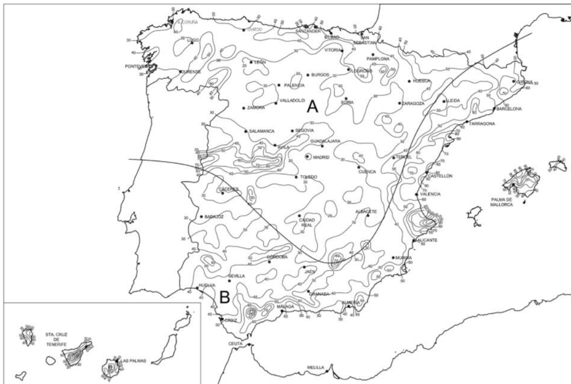
Ilustración 2: Zona pluviométrica e isoyeta
