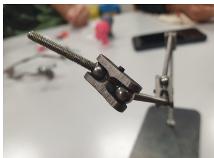
Fig. 8. Ejemplo de un rig o esqueleto externo realizada con articulaciones a bolas
