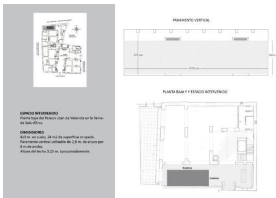
Fig. 54 Planta baja del Palacio Joan de Valeriola, y plantas de distribución de la Sala d’Arcs y adyacentes.
