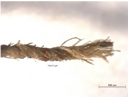
Figura 34: Hilo vertical. Microfotografía realizada con la lupa binocular Leica S8APO a x25.
