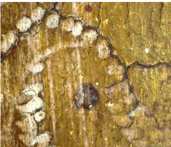
Figura 64: Grietas en la incisión del cincelado. Fotografía realizada con Dinolite a x50.
