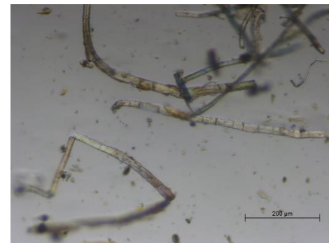
Figura 37: Fibras del hilo de la tela original. Microfotografía realizada con el microscopio Leica DM 750 a x100.
