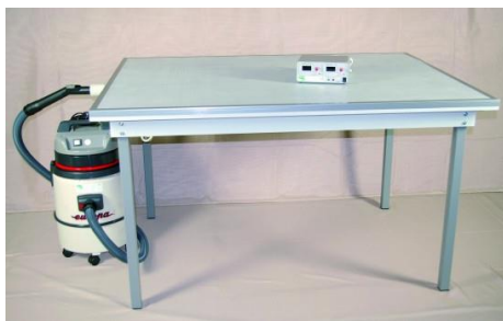
Figura 67: Mesa de baja presión que permite una distribución rápida y uniforme de la temperatura y de la aspiración en todo el plano de trabajo.
