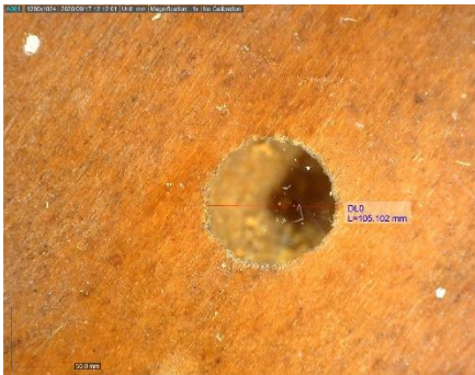
Figura 55: Orificio resultante del ataque de anobium punctatum en la madera del bastidor. Fotografía realizada con Dinolite a x50.
