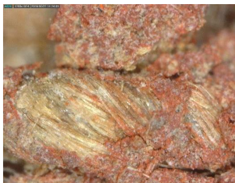
Figura 43: Restos de preparación almagra sobre hilos del soporte original. Fotografía realizada con Dinolite a 50x.
