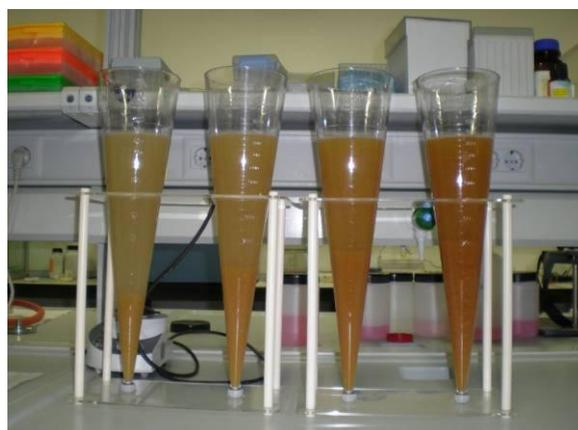
**Ilustración 49. Determinación de  $V_{30}$  con cloruro férrico. Muestra Sanotan**
