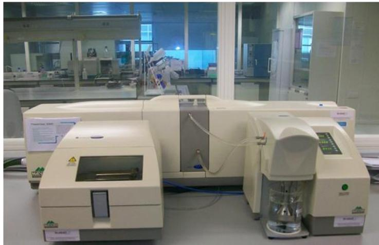
**Ilustración 21. Equipo para la determinación de tamaño de partícula: Mastersizer 2000.**
