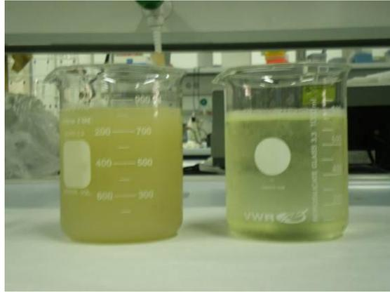
**Ilustración 73. Muestra Sanotan antes y después del uso de membrana de microfiltración**
