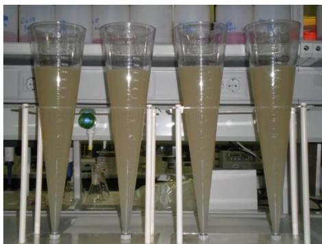
**Ilustración 50. Determinación de la dosis óptima de sulfato de aluminio. Sanotan**
