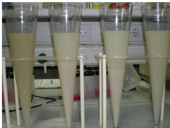
**Ilustración 54. Determinación de V30 con adición de ácido. (Sanotan)**
