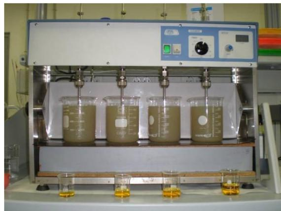
**Ilustración 48. Test de jarra con cloruro férrico. Muestra Sanotan**
