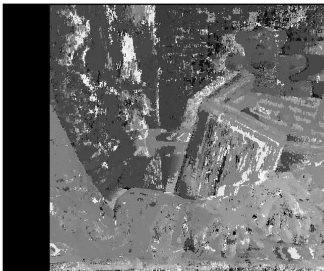
Figura 29: Mapa de disparidad generado por el clasificador entrenado utilizando 160 muestras sintéticas generadas aleatoriamente.
