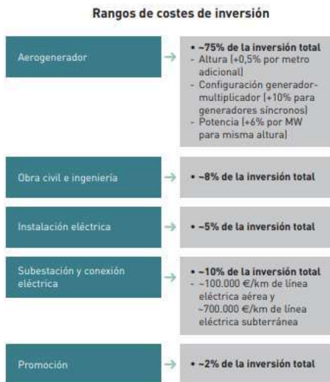
Figura 29. Rangos de costes de inversión de un parque eólico. Fuente: Plan de Energías Renovables 2011-2020.
