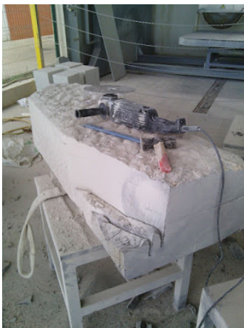
Figura 18: Rebaje e igualado de la superficie
