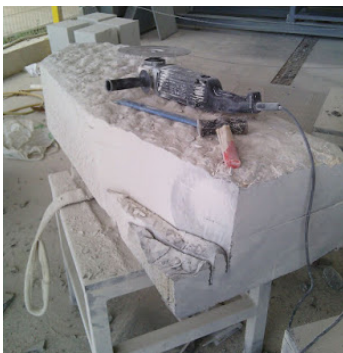
Figura 5: Desbaste inicial con la maquinaria utilizada
