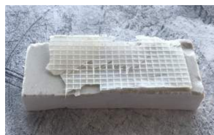
Figura 13: Piedra con malla de refuerzo
