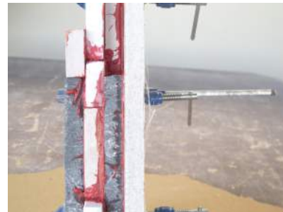
Figura 21: Aplicación de presión mediante gatos
