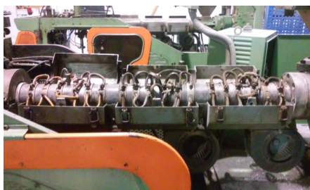
Figura 5: Calentadores de las zonas 1, 2 y 3
