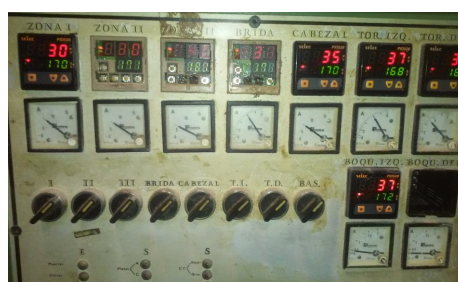
Figura 6: Panel de control con PIDs
