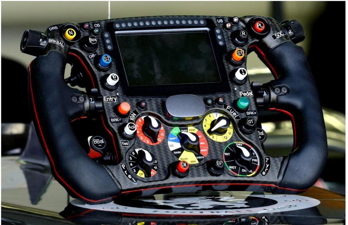
Ilustración 22. Volante con dashboard integrado del Sauber C33 2014
