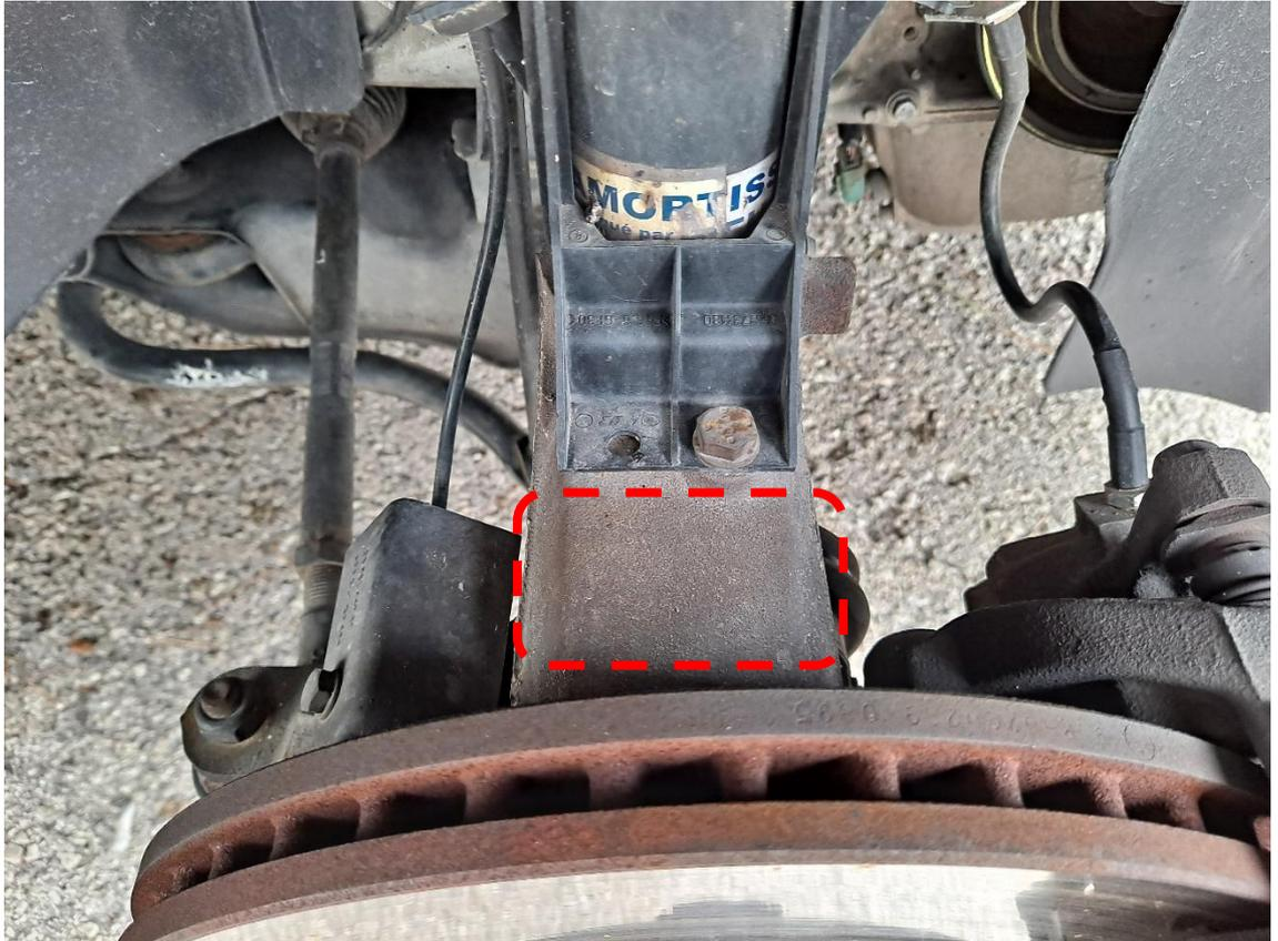
*Ilustración 89. Mangueta delantera (autor)*
