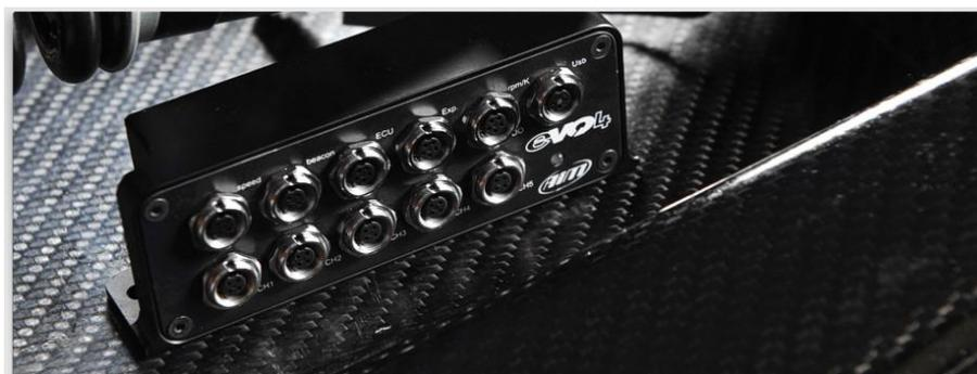
Ilustración 26. Data logger EVO4 de AIM
