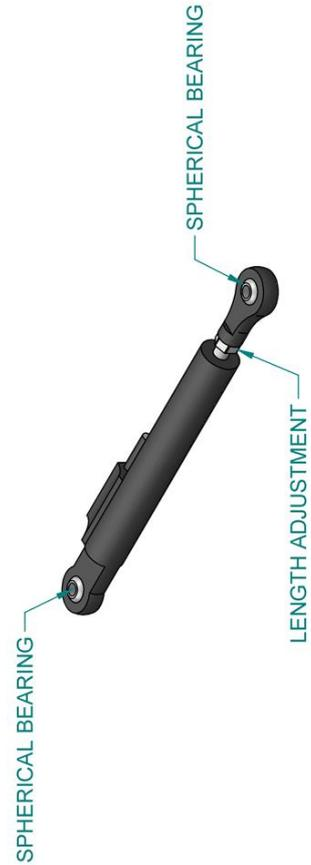
Ilustración 96. Suspensión delantera y LVDT
