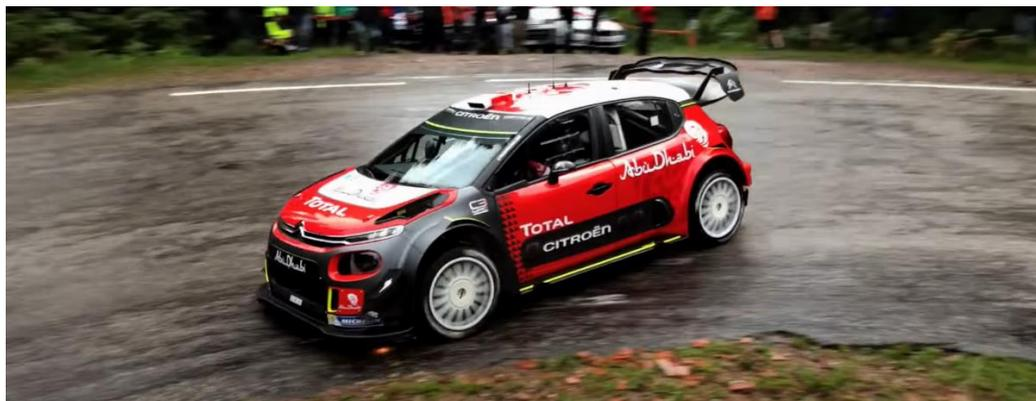
*Ilustración 38. Sebastien Loeb en un test sobre asfalto con el Citroën C3 WRC. La luz bajo el paragolpes delantero es el sensor de altura de carrocería*
