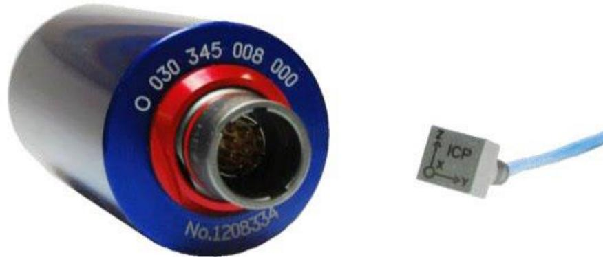
Ilustración 34. IEPE Interfaz del acelerómetro
