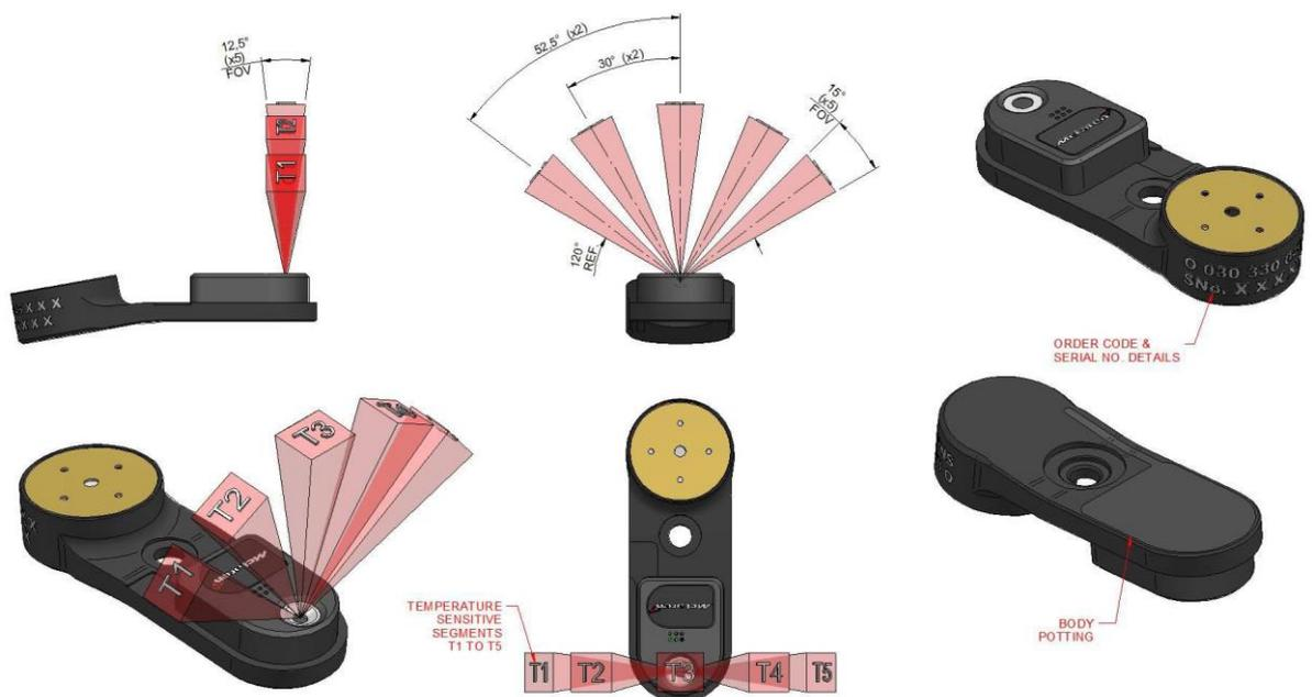
Ilustración 46. Croquis del sensor de presión de neumáticos y medida de 5 puntos de temperatura de neumáticos
