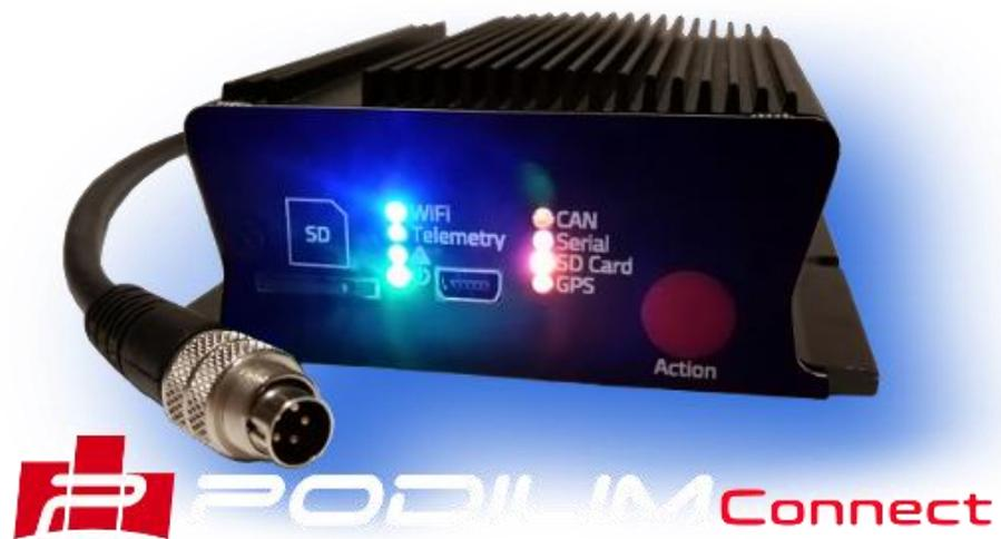
Ilustración 88. Unidad de telemetría Podium Connect
