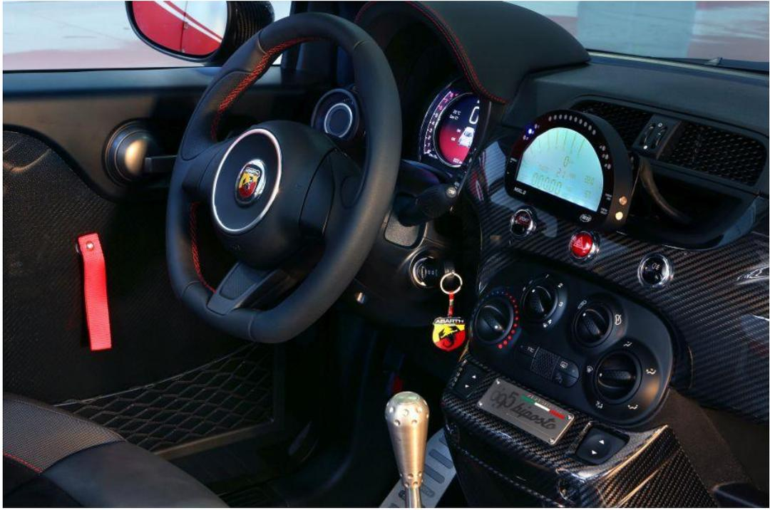
*Ilustración 16. Dash Logger de un Abarth 695 Biposto*
