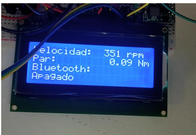
**Figura 6.2:** Velocidad medida por el sistema embebido mostrada en el *LCD*
