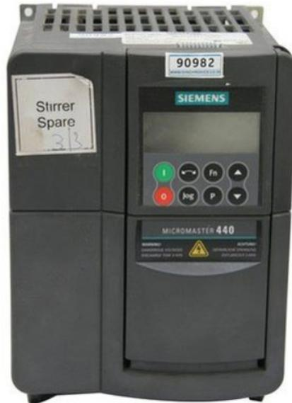
**Figura 2.6:** Variador de frecuencia Micromaster 440
