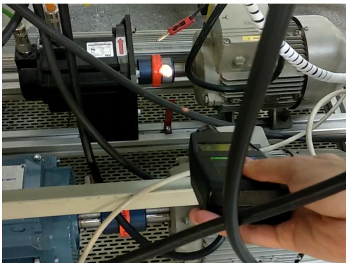
**Figura 6.1:** Medida de la velocidad con tacómetro
