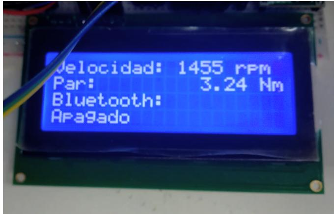
**Figura 6.4:** Par medido por el sistema embebido mostrado en el *LCD*
