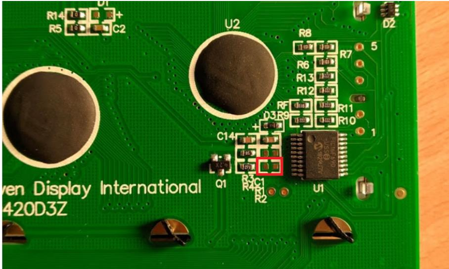
Figura 3.9: Configuración del LCD para protocolo SPI
