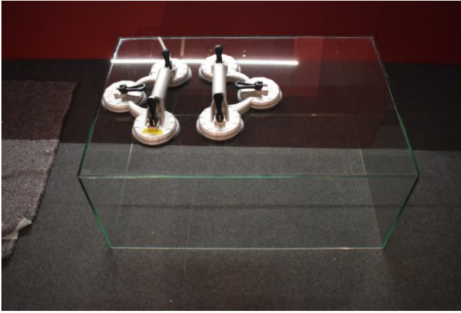
Fig. 5. Sistema de movilización y colocación de campanas
