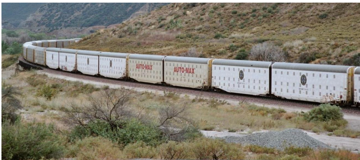
Ilustración 26. Vagones Auto-Max para el transporte Automotriz. (Transporte.mx, 2019b).
