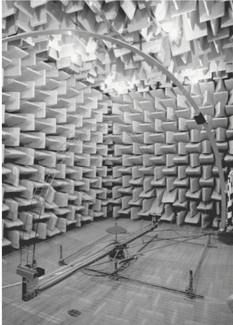
Fig. 11 - Medición según ISO 17497-2.
