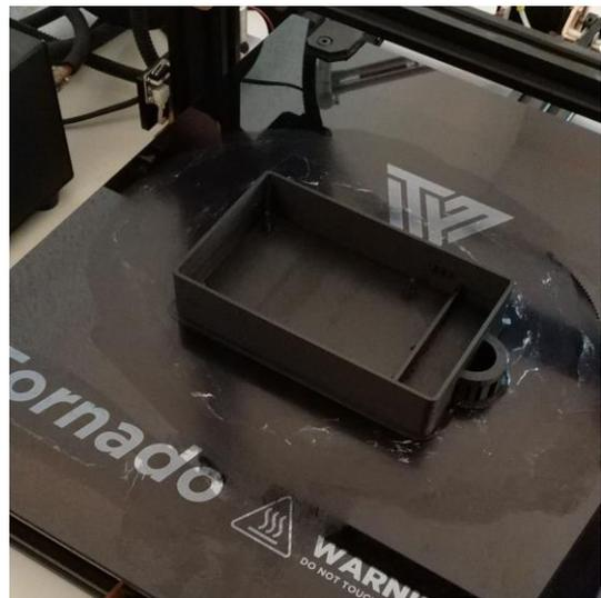
*Figura 20. Caja prototipo impresa en 3D.*
