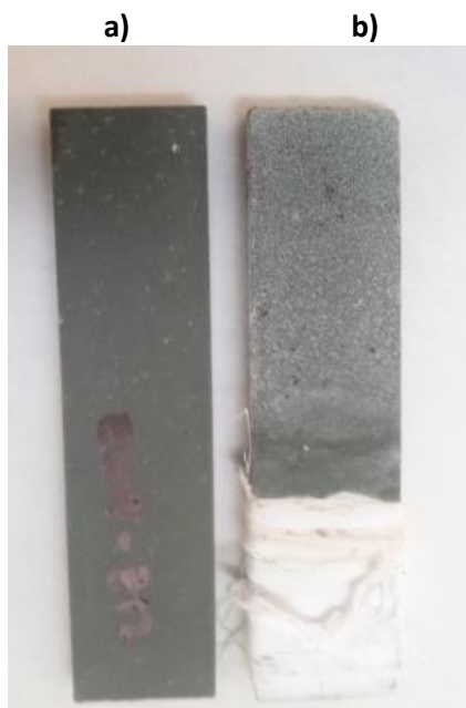
Figura 4. 46. Fotografía de a) un electrodo cerámico de CuO nuevo y b) otro utilizado como ánodo para la electro-oxidación del NOR en medio \text{Na}_2\text{SO}_4 .
