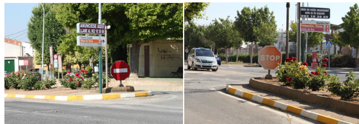
Figura 10: Señales con altura inferior a 2,2 m
