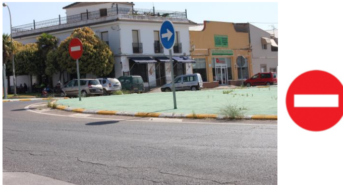
Figura 23: Señal de Prohibición de Entrada en isleta central de la glorieta
