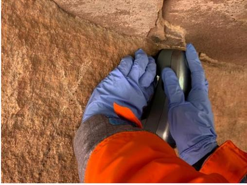
Figura 55. Medición colorimétrica *in situ* antes de aplicar productos consolidantes. Fuente: SERRANO, 2020.
