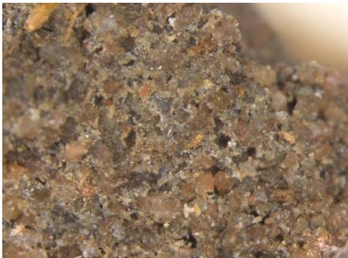
**Figura 23.** Detalle de mortero y su porosidad. Fuente: SERRANO, 2020.
