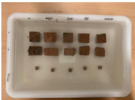
**Figura 96.** Probetas sumergidas en solución salina. Fuente: SERRANO, 2020.
