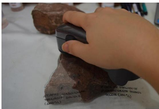
**Figura 1.** Medición colorimétrica con colorímetro *X-Rite® Eye-One Defined*. Fuente: SERRANO, 2020.
