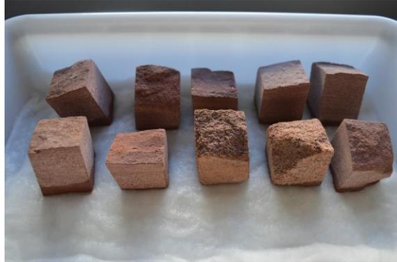
**Figura 98.** Probetas tratadas y sin tratar sobre lecho permeable con agua destilada para la determinación de la absorción de agua por capilaridad.
