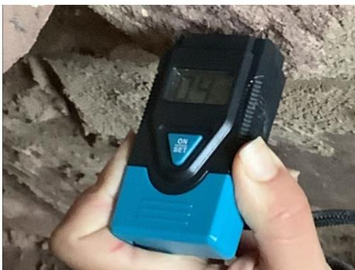
**Figura 1.** Medición de humedad relativa del muro de cerramiento mediante higrómetro de contacto. Fuente: SERRANO, 2020.
