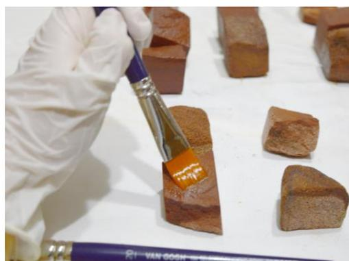
**Figura 10.** Aplicación de consolidantes en laboratorio sobre probetas. Fuente: SERRANO, 2020.
