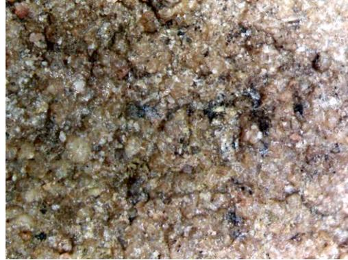
**Figura 70.** Probeta de *Nano Estel®-2*, tras la aplicación antes de someterse al ciclo de envejecimiento (57x). Fuente: SERRANO, 2020.
