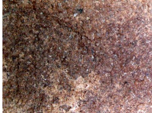
**Figura 62.** Probeta de Wacker® OH100-2, tras la aplicación antes de someterse al ciclo de envejecimiento (57x). Fuente: SERRANO, 2020.
