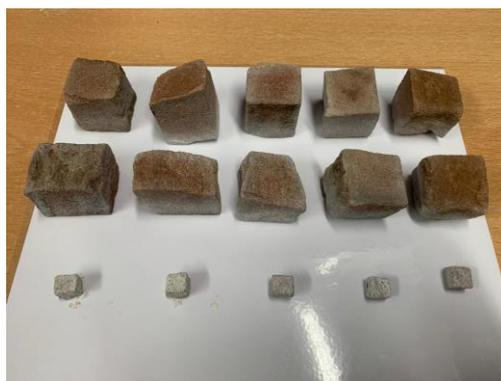
**Figura 97.** Probetas tras un ciclo de cristalización de sales. Fuente: SERRANO, 2020.
