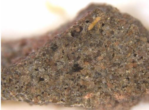
**Figura 21.** Corte transversal de mortero de cerramiento. Fuente: SERRANO, 2020.
