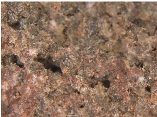
**Figura 27.** Detalle de la elevada porosidad del mortero. Fuente: SERRANO, 2020.
