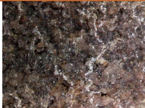
**Figura 67.** Probeta de *Tecnadis® Solidus-2*, tras someterse al ciclo de envejecimiento. Se aprecia una posible contracción del consolidante por posible acumulación serpenteante blanquecina (57x). Fuente: SERRANO, 2020.
