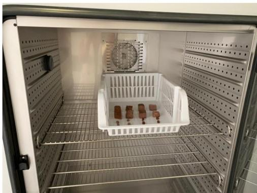
**Figura 59.** Probetas en el interior de la cámara climática previo al inicio del ciclo de envejecimiento. Fuente: SERRANO, 2020.
