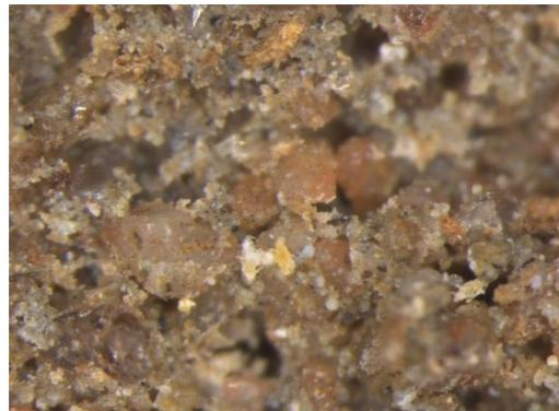
**Figura 24.** Clastos de diversa naturaleza componen en mortero. Fuente: SERRANO, 2020.
