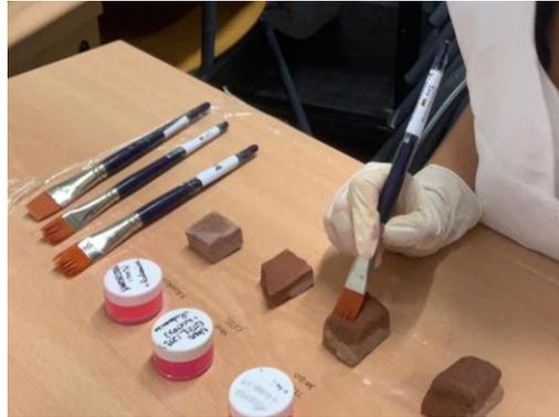
Figura 98. Aplicación de productos consolidantes con Rodamina B mediante impregnación con pincel. Fuente: SERRANO, 2020.
