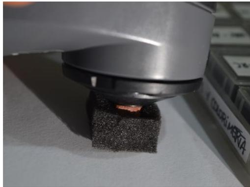
Figura 58. Medición colorimétrica en las probetas (1x1x1 cm) antes de aplicar los productos consolidantes. Fuente: SERRANO, 2020.
