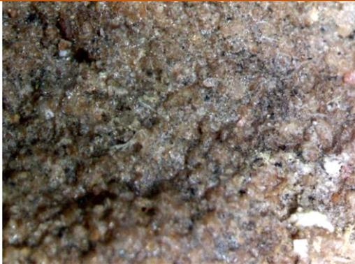
**Figura 69.** Probeta de *Nano Estel®-1* tras someterse al ciclo de envejecimiento. No se aprecia modificación superficial (57x). Fuente: SERRANO, 2020.
