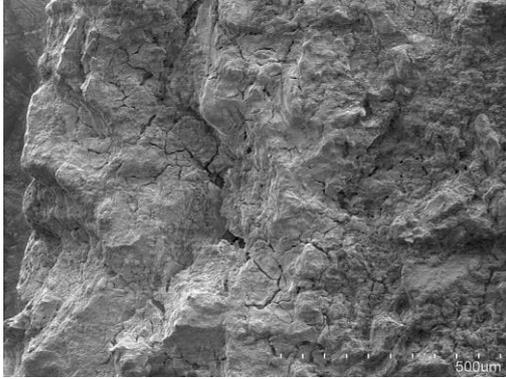
**Figura 92.** Probeta de *Nanorestore®-I* tras la aplicación antes de someterse al ciclo de envejecimiento. Se observa agrietamiento en zonas con mayor acumulación de producto (110x). Fuente: SERRANO, 2020.
