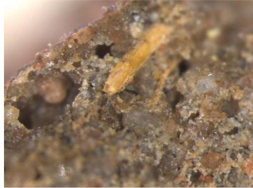
**Figura 22.** Detalle de porosidad de mortero y restos vegetales. Fuente: SERRANO, 2020.
