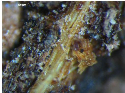
**Figura 4.** Detalle de tallo con posibles restos de resina incrustado en el material pétreo (63x). Fuente: SERRANO, 2020.
