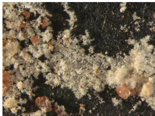
**Figura 20.** Sales procedentes del muro de cerramiento con morfología filamentososa y presencia de granos de sílice (63x). Fuente: SERRANO, 2020.
