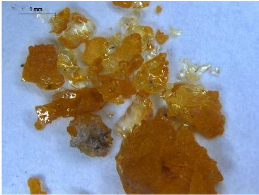
**Figura 34.** Resina proyectada sobre el interior del muro de cerramiento (8x). Fuente: SERRANO, 2020.
