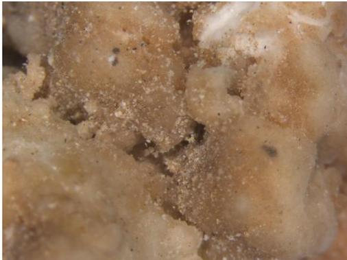
**Figura 28.** Aspecto superficial de concreción calcárea, se aprecia agrietamiento y tonalidad parda. Fuente: SERRANO, 2020.
