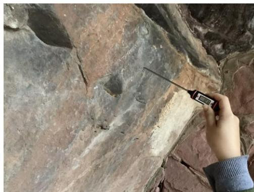
**Figura 2.** Medición de la temperatura superficial del soporte mediante termómetro de contacto. Fuente: SERRANO, 2020.
