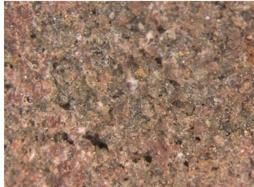
**Figura 26.** Superficie de mortero, donde se observa su porosidad. Fuente: SERRANO, 2020.
