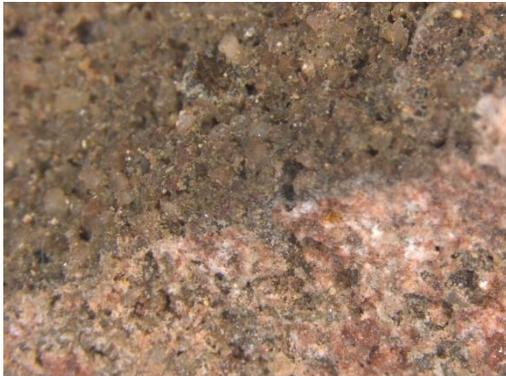
**Figura 25.** Diferencia de color en el mortero. Fuente: SERRANO, 2020.
