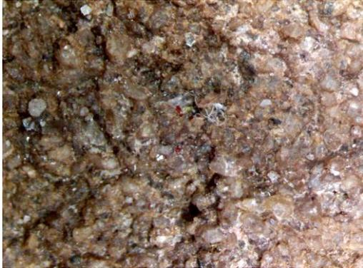
**Figura 60.** Probeta de Wacker® OH100-1, tras la aplicación antes de someterse al ciclo de envejecimiento (57x). Fuente: SERRANO, 2020.
