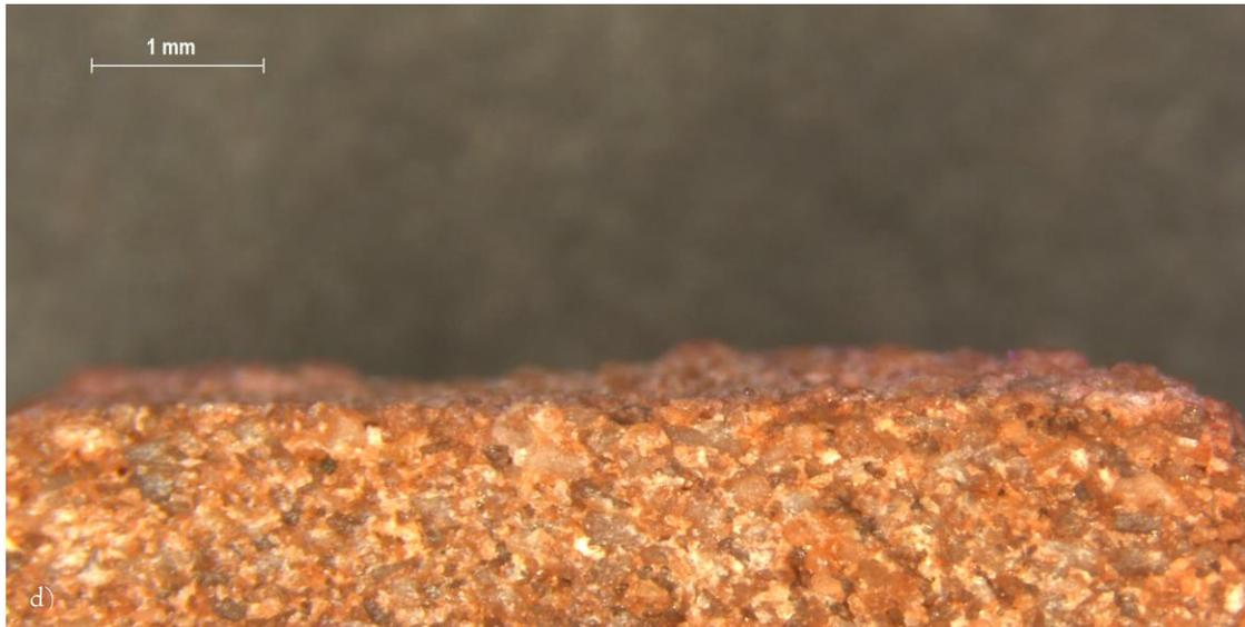
**Figura 100.** Probetas tratadas con *Rodamina B* para determinar el nivel de penetración de *Nanorestore*®; (c) Imagen adquirida con microscopía de fluorescencia (10x); (d) Imagen adquirida con microscopía MEST (8x). Fuente: SERRANO, 2020.
