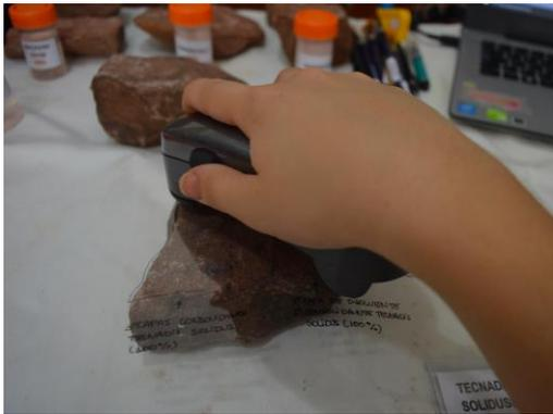
Figura 57. Medición colorimétrica de las muestras de material pétreo para su testado empírico. Fuente: SERRANO, 2020.
