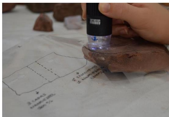
**Figura 2.** Toma de imágenes del material pétreo con microscopio digital *DigiMicroscope USB Reflecta®*. Fuente: SERRANO, 2020.
