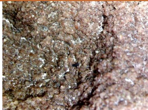
**Figura 75.** Probeta de *Nanorestore®-2* tras someterse al ciclo de envejecimiento. No se aprecia modificación superficial (57x). Fuente: SERRANO, 2020.
