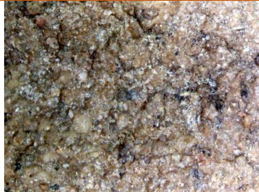
**Figura 71.** Probeta de *Nano Estel®-2*, tras someterse al ciclo de envejecimiento. No se aprecia modificación superficial (57x). Fuente: SERRANO, 2020.
