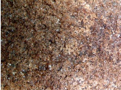
**Figura 64.** Probeta de *Tecnadis® Solidus-1*, tras la aplicación antes de someterse al ciclo de envejecimiento (57x). Fuente: SERRANO, 2020.
