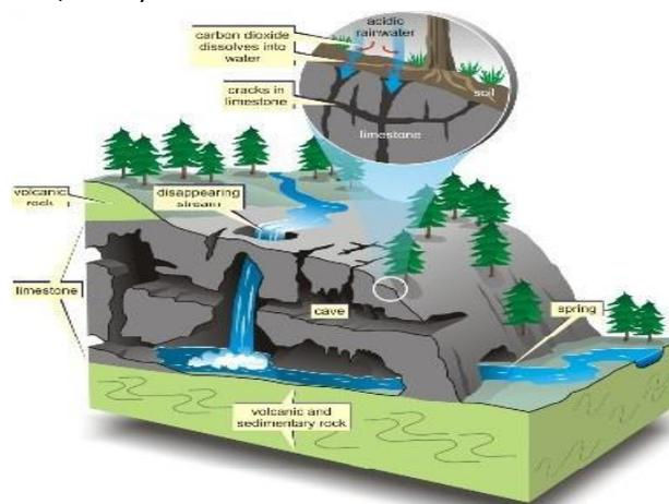
Figura 6. Esquema simplificado de un sistema kárstico
