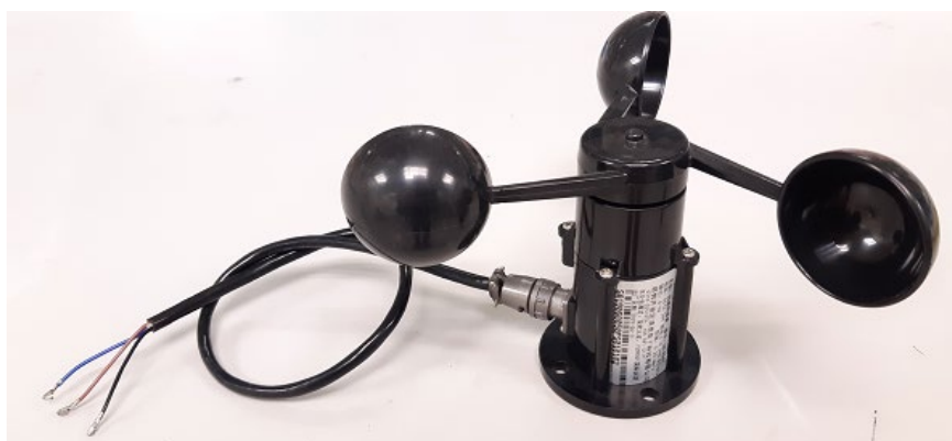
Figura 23. Anemómetro de tres copas.
