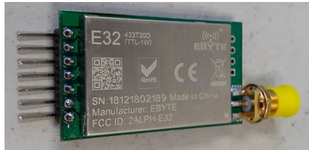
Figura 21. Soldadura de los pines del módulo de radio.
