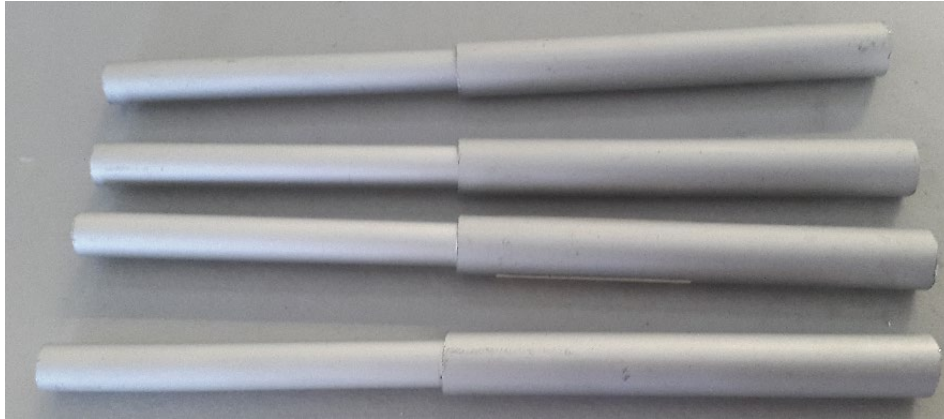
Figura 3. Pilares de aluminio para la pantalla de sensores.
