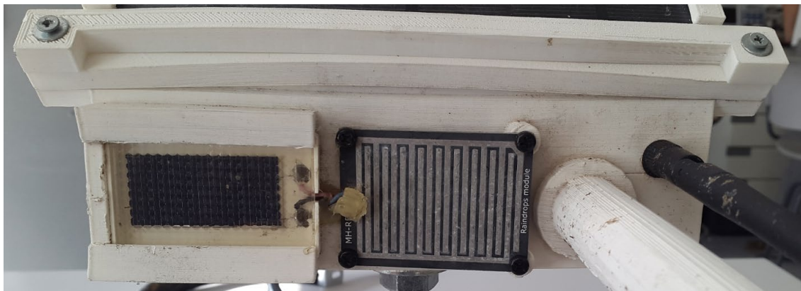
Figura 60. Deformaciones y daños observados en los primeros prototipos.
