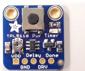
Figura 20. Módulo temporizador TPL5110.
