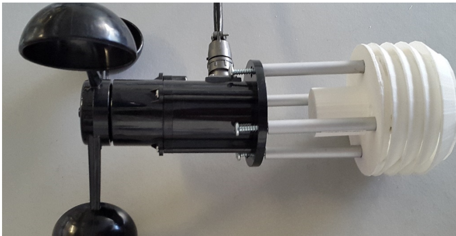
Figura 6. Montaje del anemómetro de copas.
