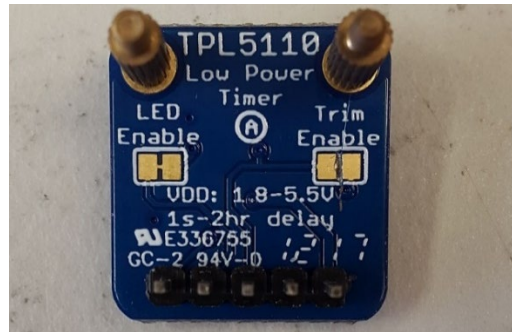
Figura 18. Soldadura y preparación del timer TPL5110.
