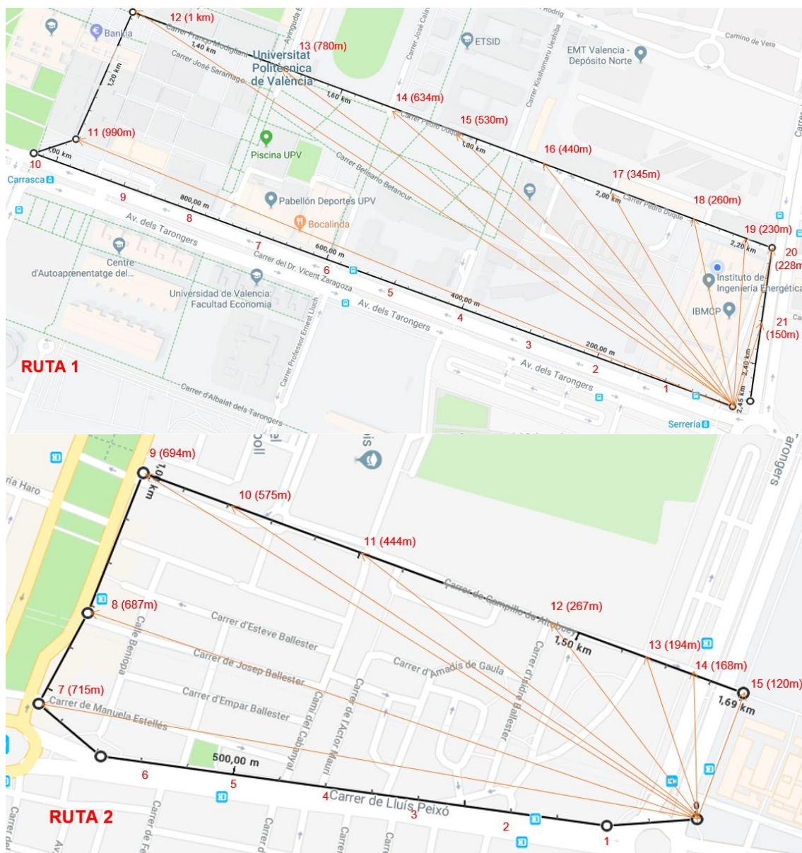
Figura 67. Rutas seguidas durante la prueba de rango de antenas.
