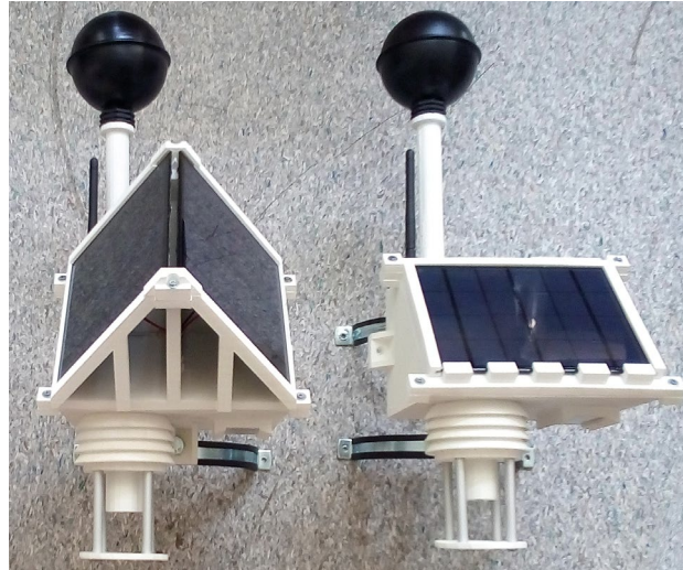
Figura 7. Versiones de transmisor con uno y dos paneles solares.
