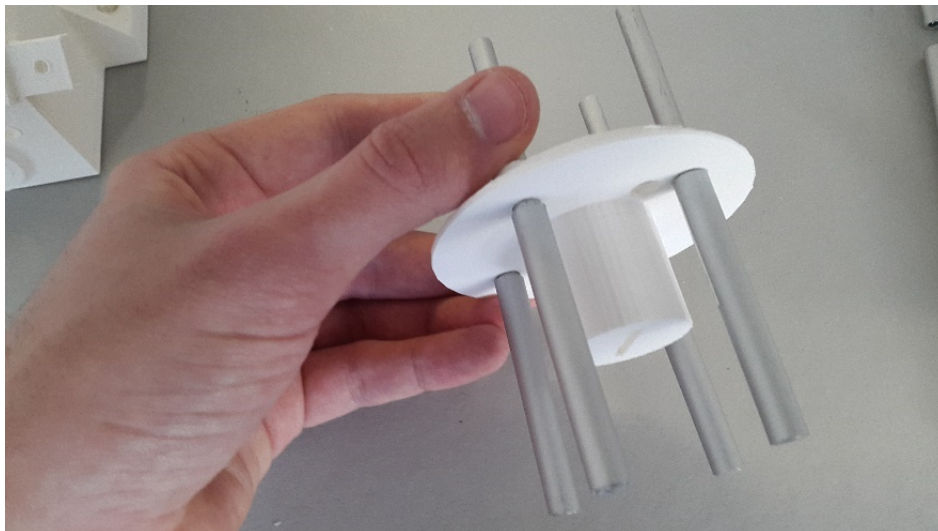
Figura 4. Montaje del soporte del sensor de viento.
