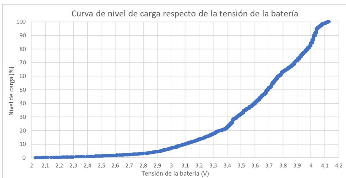
Figura 74. Gráfica del nivel de carga respecto de la tensión de la batería.
