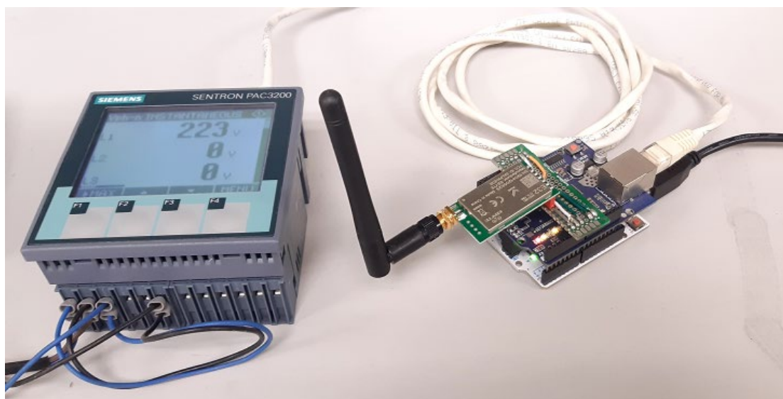
Figura 75. Montaje de transmisor con Arduino UNO y analizador de redes.
