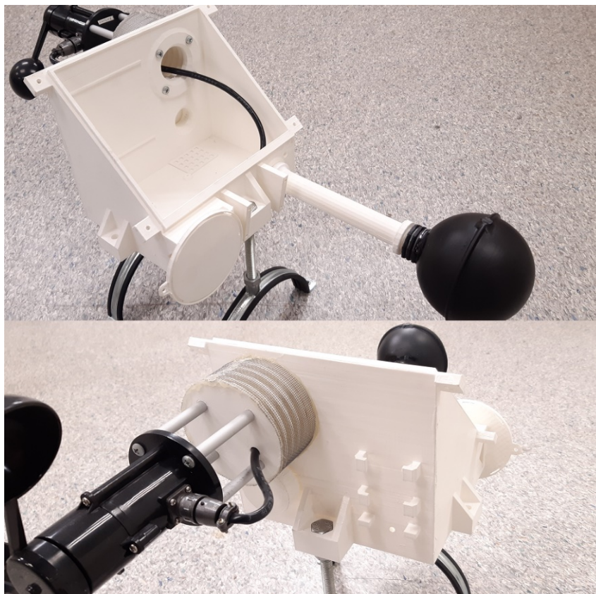
Figura 28. Caja del transmisor montada sin electrónica.
