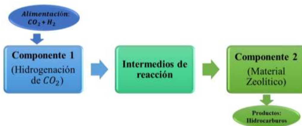
Figura 4. Concepto de catalizador bifuncional o híbrido utilizado en la hidrogenación indirecta de CO_2 a hidrocarburos.
