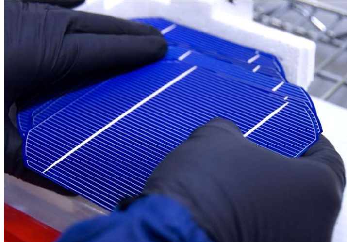
Figura 2: Célula fotovoltaica silicio monocristalino
