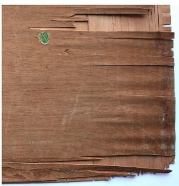
*Fig 20.* Detalle del reverso con zonas de pérdidas y levantamientos de las chapas.
