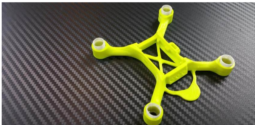
Figura I.14 Chasis de dron impreso mediante FDM con filamento de ABS fosforito.
