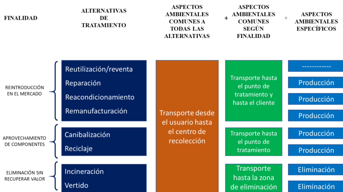
Figura 307. Estructura de aspectos que componen el impacto ambiental de las alternativas de LI (Elaboración propia).
