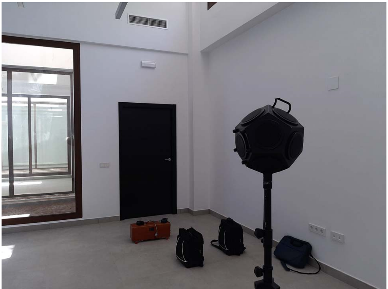
Figura 39_ Aislamiento acústico ruido aéreo
