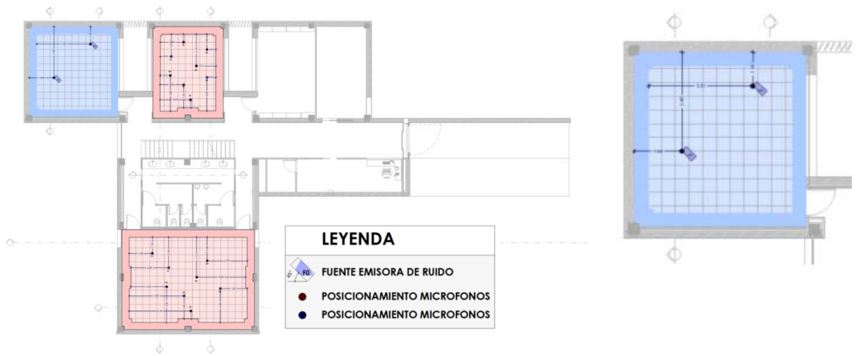
Figura 36_ Plano medición "in situ" Ruido de impacto y zona donde se ubicaron las fuentes de ruido local emisor (color azul)
