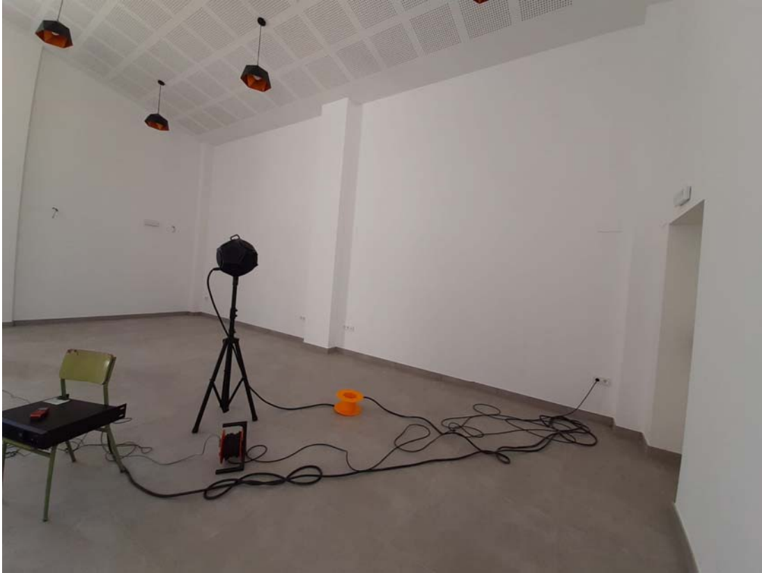
Figura 40_ Comprobación de TR En Sala multiusos
