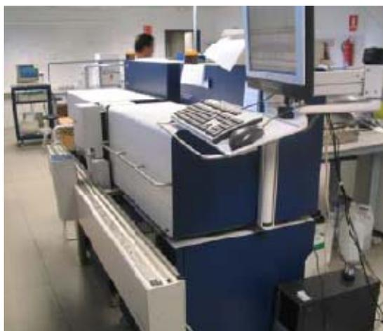
**Figura 1.** Equipo utilizado para el análisis del RCS (Fossomatic 5000).
