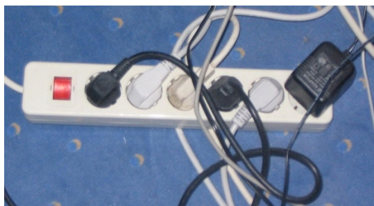
Figura 18. Regleta sobrecargada. Fuente: Wikimedia
