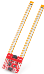
Ilustración 52: Sensor digitalizado para transmisión de datos por protocolo I2C. [28]
