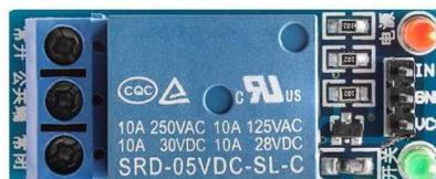
Figura 8 – Módulo Relé KF-301. [Imagen]. Recuperado de <https://www.az-delivery.de/es>. (2020)
