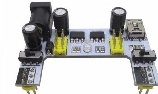
Figura 16 – Fuente de alimentación para protoboard. [Imagen]. Recuperado de [www.geekbotelectronics.com](http://www.geekbotelectronics.com). (2020)
