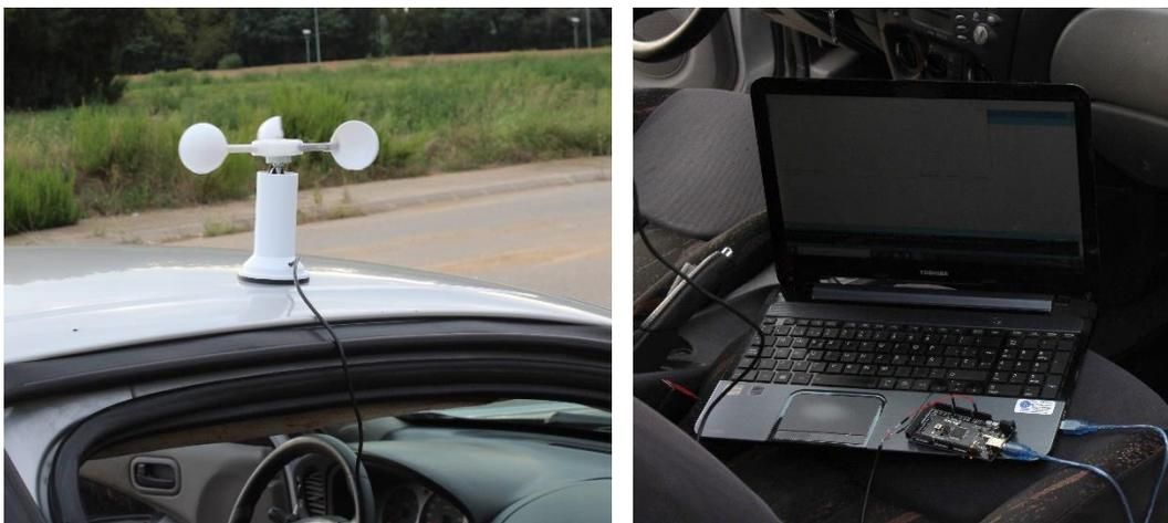
Figura 28.a y 28.b – Anemómetro fijado al techo (izquierda) y conexión con la placa de desarrollo y el ordenador (derecha)
