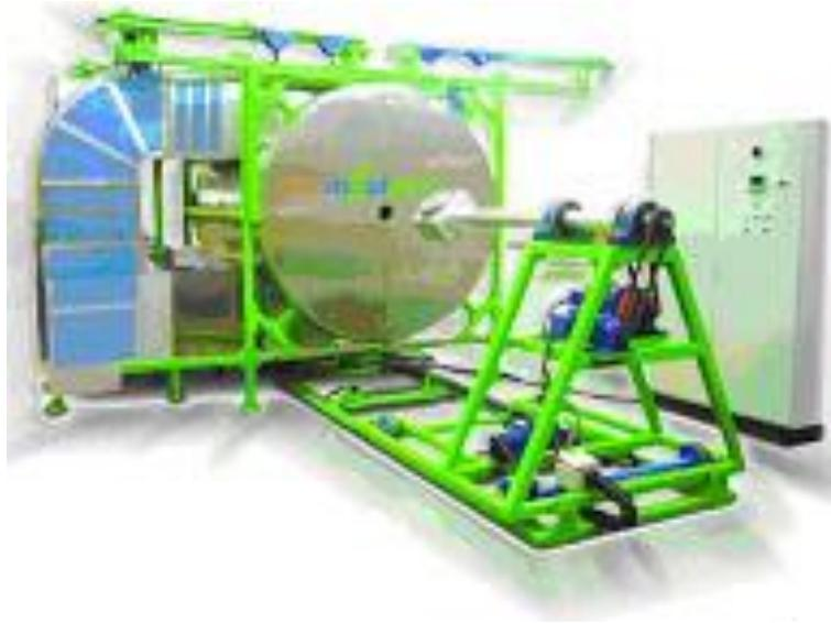
Figura I.6. Máquina de rotomoldeo de desplazamiento lineal.
