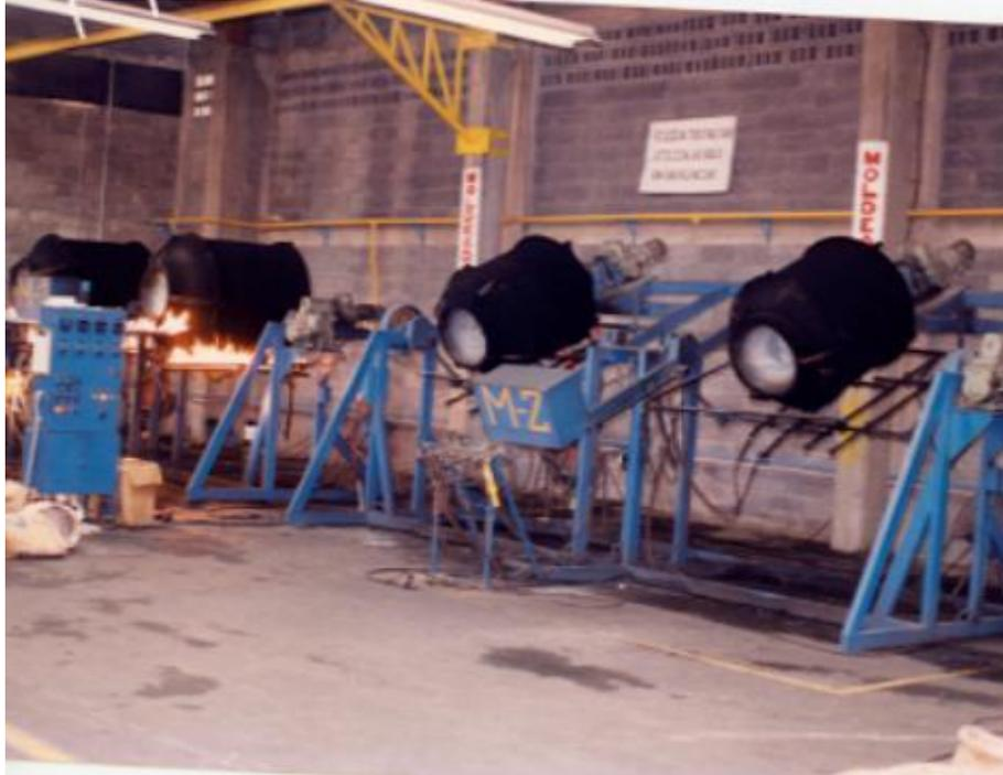
Figura I.11. Equipos de flama abierta de un solo brazo.
