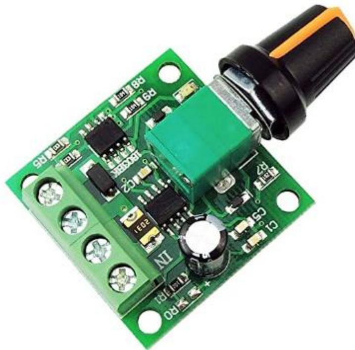
Figura III.30. Variador de velocidad para motor de corriente continua.
