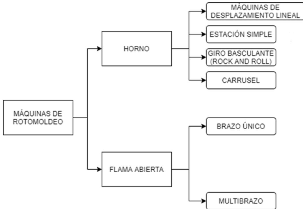
**Figura I.5.** Clasificación de los equipos de rotomoldeo atendiendo a la forma de aplicar calor al molde.
