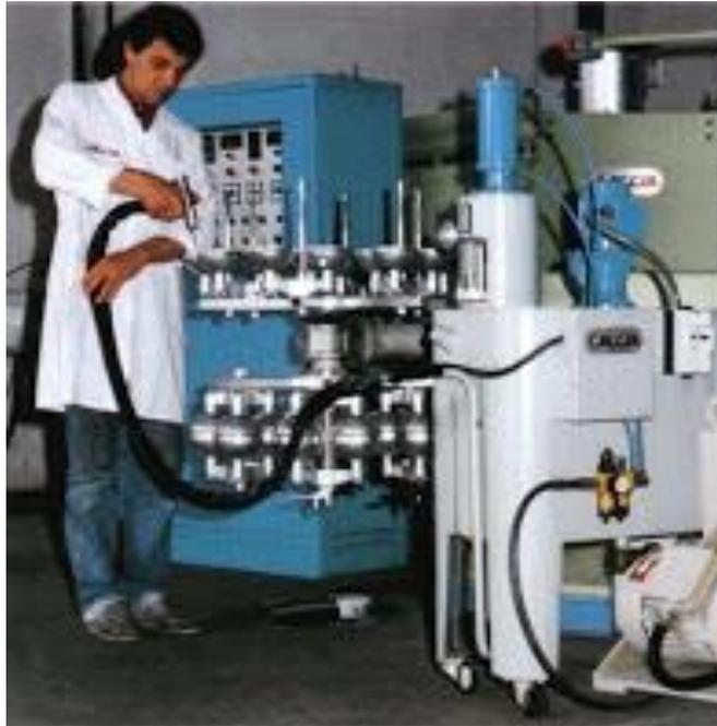
Figura I.5. Carga de material líquido (plastisol) mediante pistola.
