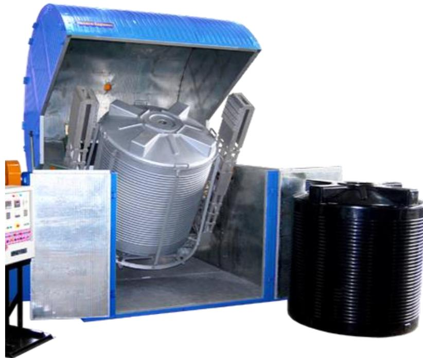
Figura I.7. Estación simple de moldeo rotativo.
