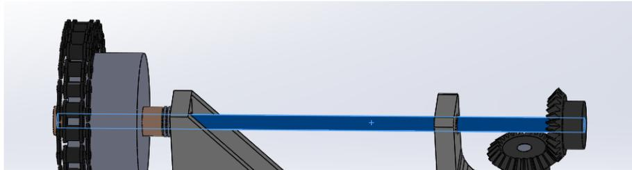
**Figura III.10.** Eje que conecta un piñón con uno de los piñones.
