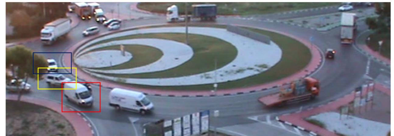
Ilustración 20: Trenzado de vehículos que acceden y abandonan la glorieta entre las Zona 1,2 y 3. Fuente: Elaboración propia
