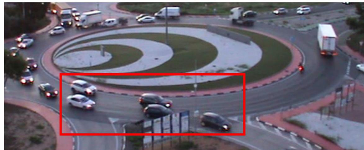
Ilustración 24: Vehículos circulando en paralelo que deben acceder a un único carril. Fuente: Elaboración propia.
