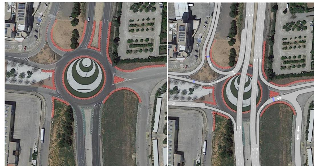
Ilustración 108: Tramo 1 – Supresión de glorieta actual por dos carriles por sentido. Fuente: Elaboración propia
