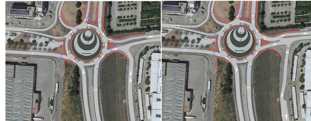
Ilustración 82: Modificación de infraestructura viaria en la glorieta en Alternativa 2. Fuente: Elaboración propia
