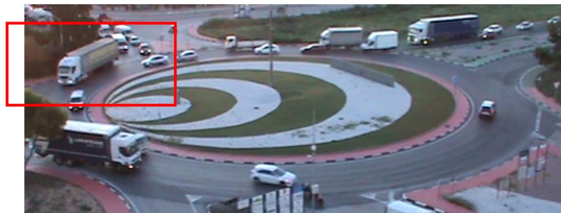
Ilustración 31: Vehículo pesado accede a glorieta provocando que vehículos en el interior de la glorieta frenen bruscamente. Fuente: Elaboración propia.
