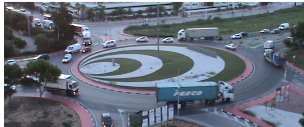
Ilustración 30: Utilización del carril derecho por vehículos pesados. Impiden el acceso al carril izquierdo al resto de veh. Ligeros. Fuente: Elaboración propia.
