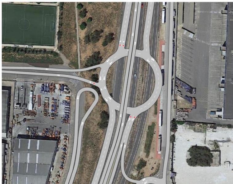
Ilustración 112: Estructura y glorieta propuesta en el P.K. 0+500 de la Carretera CV-374. Fuente: Elaboración propia
